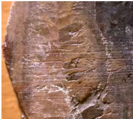
Stopy po řezání kamene na rubové straně desky odebrané při průzkumu z kaple sv. Václava na Karlštejně (foto archiv F. Skřivánka)
